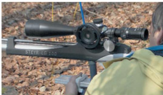
***Популярный прицел Nikko Stirling Diamond 10-50x60. Виден оригинальный механизм регулировки параллакса с помощью ремённой передачи***
