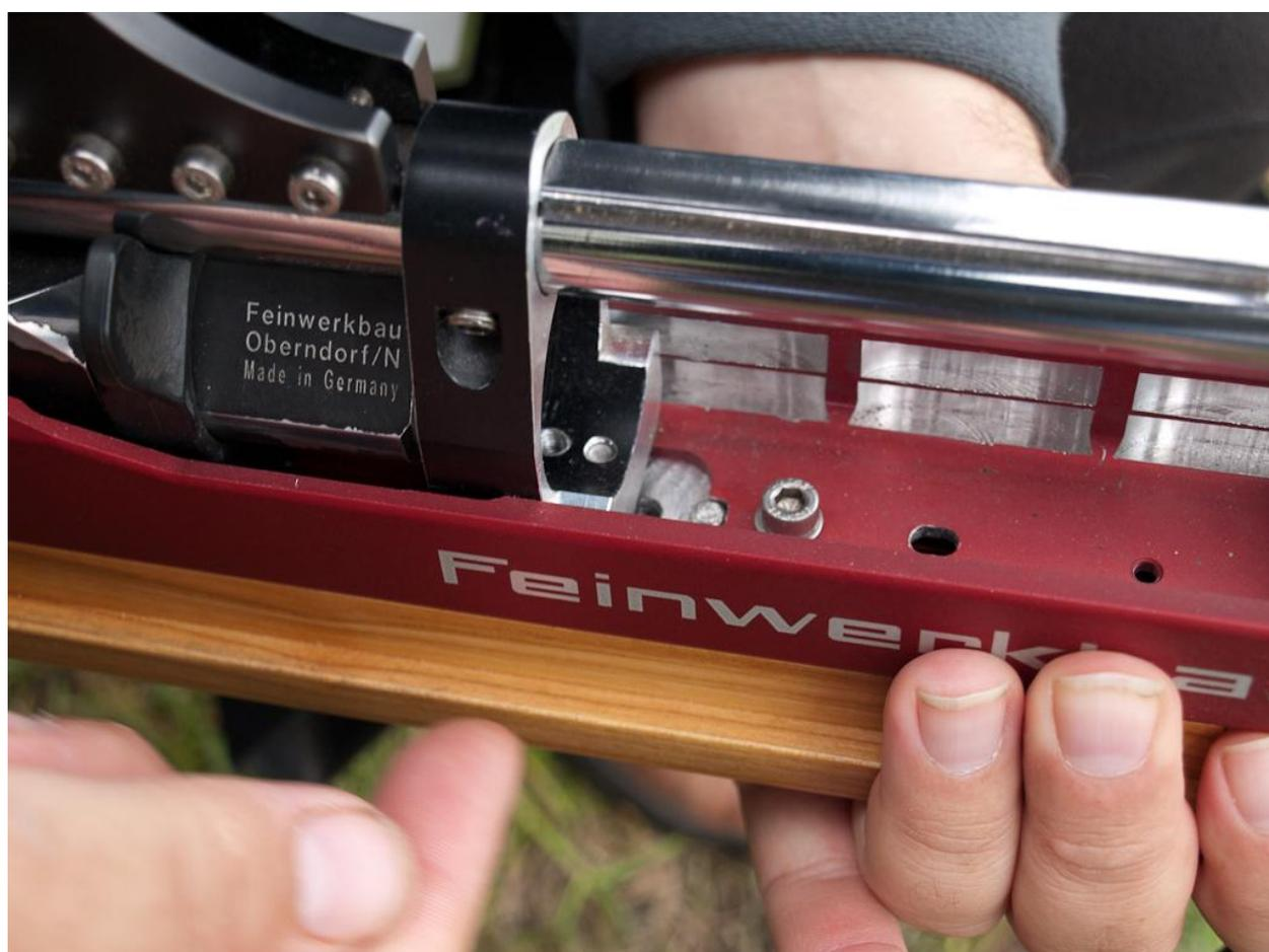
Вот так переносится восьмерка, она стала немного уже, и закреплена парой винтов через еврошину штатной дюралевой ложки.
