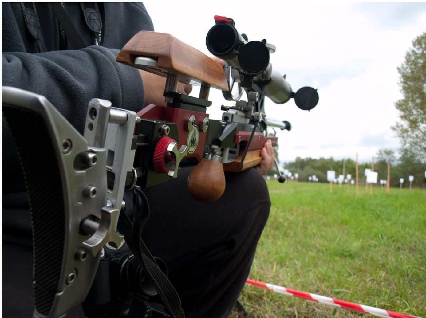
Во первых, для облегчения передней части винтовки, которая и без 200 граммового тюнера на толстенном стволе имеет очень ярко выраженный передний баланс, Андраш цинично отпилел "лишний" кусок цевья. Кроме того, внутри выфрезерованы полости, чтобы снизить вес цевья не снижая его прочности.
