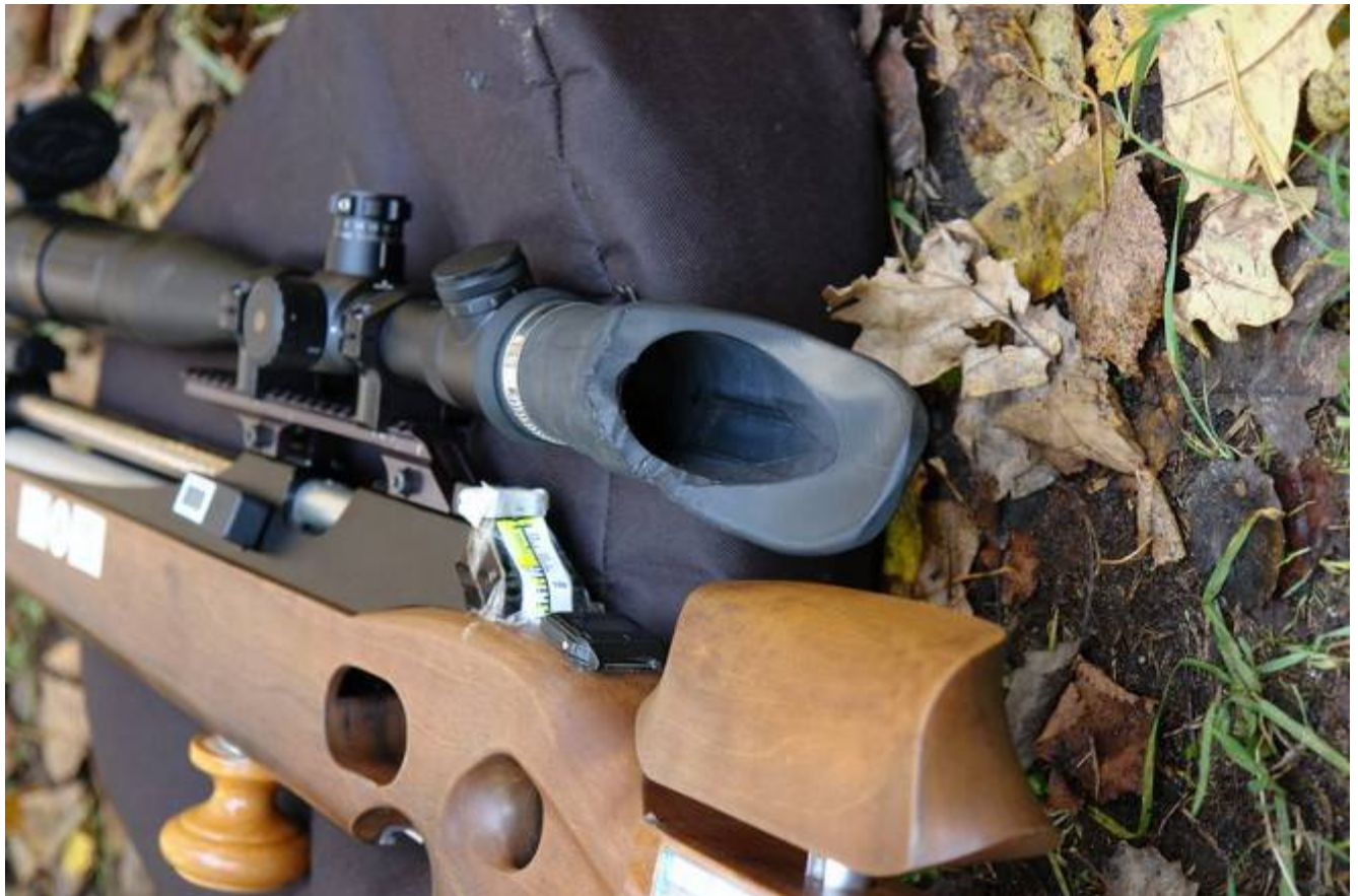
Жесткий наглазник обеспечивает однообразную прикладку.
